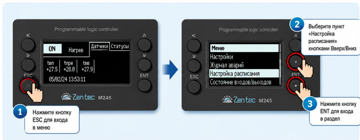
Рис. 1. Переход в раздел «Настройка расписания» в меню контроллера M245
